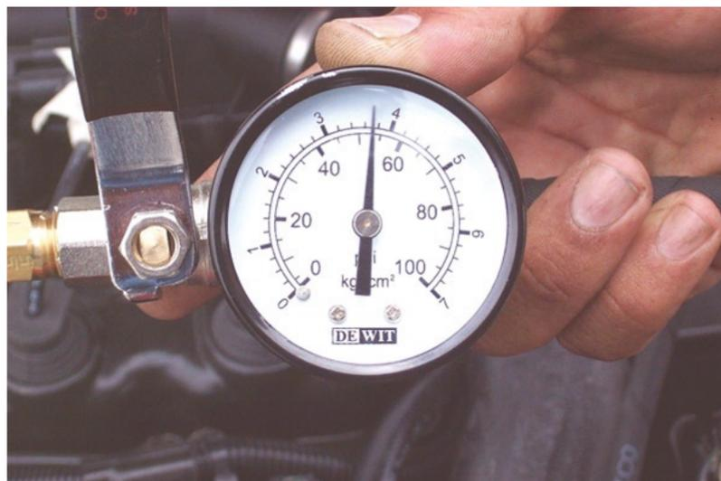
Y por último, compara la presión obtenida con la presión indicada por el fabricante y verifica que la bomba esté en buen estado.
