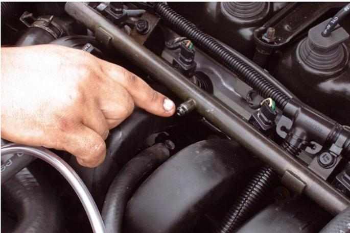
En caso que no exista la válvula de toma de presión conecta una línea de By-pass en la línea de alimentación.
