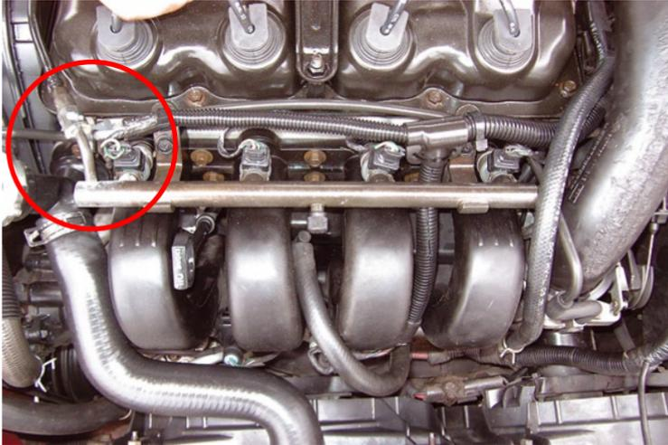
Identifica la válvula de la toma de presión en el riel de inyectores y ábrela.
